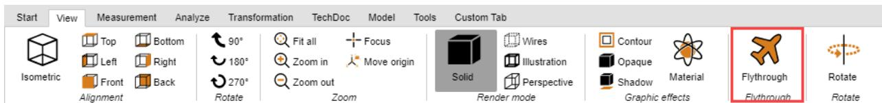
进入飞行模式时，透视渲染模式先被激活（为此参见布局调整<sup>18</sup>一章）。此时根据所需的透视布局先调整几何体的距离。为了避免相机大幅跳动，可先在视图 渲染模式下激活透视。同时根据相机朝上向量（上部已定义），飞行模式的走向保持不变，以避免相机倾斜。
