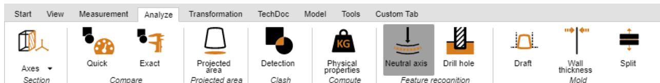
这种柱状或管状截面的纤维或层被称为中性纤维(轴线),其长度在扭转或弯曲时不会改变。使用此工具可确定圆管拉伸的长度,与弯曲度无关。基于各个段计算中性纤维。一个段被构建为两个圆周,通过一条直线连接或一个弧构建。
